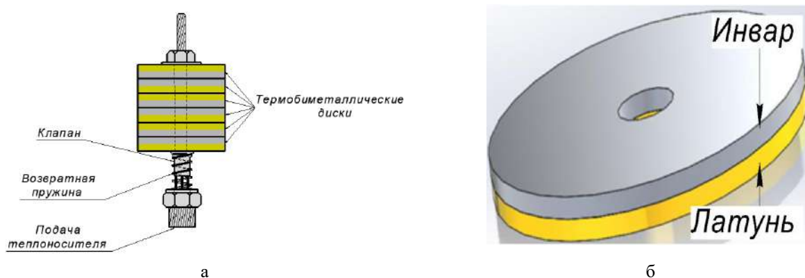
Рис. 1. Конструкция терморегулятора: а – схема терморегулятора; б – термобиметаллический диск
