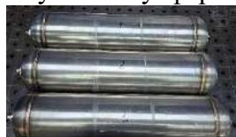
Рис. 5. Топливные баллоны, полученные с помощью лазерной сварки.
