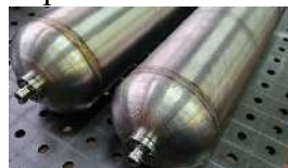
Рис. 5. Топливные баллоны, полученные с помощью лазерной сварки.
