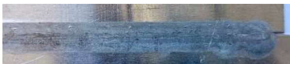
Рис. 2. СТП листов сплава АМг3 толщиной 1,2 мм. Лицевая и обратная сторона соединения.
