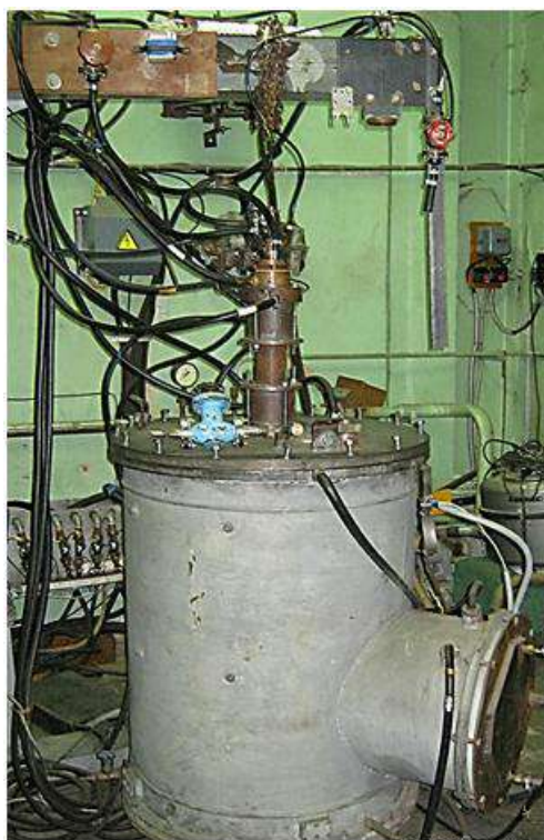
Рис. 1. Установка для плазмохимического синтеза графена
