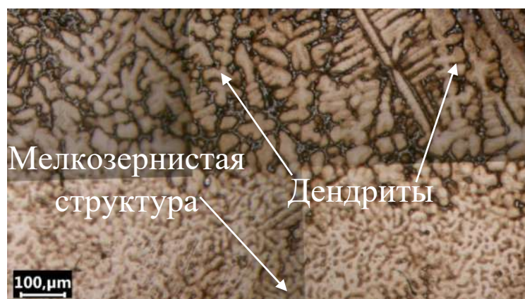
Рис. 2. Исходная структура ВЖМ7 (а); микроструктура ФГМ (б)
