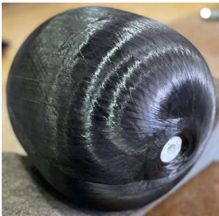
Рис. 2. Композитный баллон с полимерным термопластичным лейнером, изготовленный при помощи стандартной технологии «мокрой» намотки с последующей термообработкой
