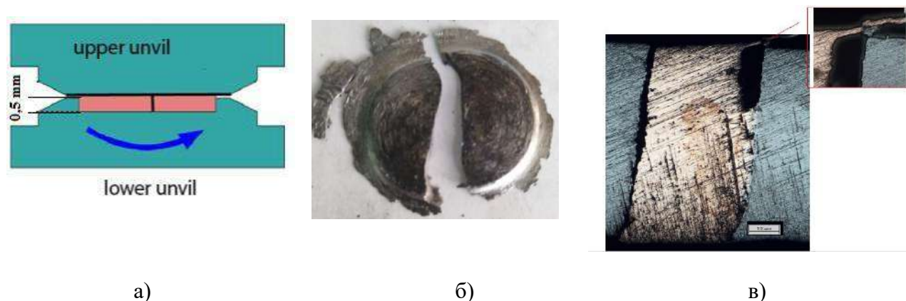
Рисунок 1. а) Схема метода «совместного ИПДК двух половин» для оценки проскальзывания; б) Две половины титанового диска после совместного ИПДК n = 1 ; в) Торцы образца Ti со вставкой Cu после предварительного ИПДК ( n=2,5 ) и ИПДК n=0,15 . Наблюдается незначительный наклон тела медной вставки (проскальзывание в толще материала >90\% , и течение полосы меди толщиной 10 мкм по поверхности Ti, выделено красным)
