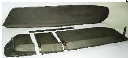
Рис. 3. Полое изделие «Крыло», полученное по технологии СПФ/ДС.
